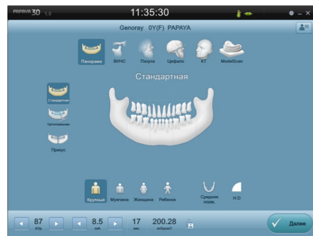
Выбор параметров экспозиции в панорамном режиме
